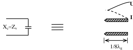
Obr. 1.24: Úsek otvoreného vedenia dĺžky 1/8 \lambda a náhradná schéma vstupnej impedancie
