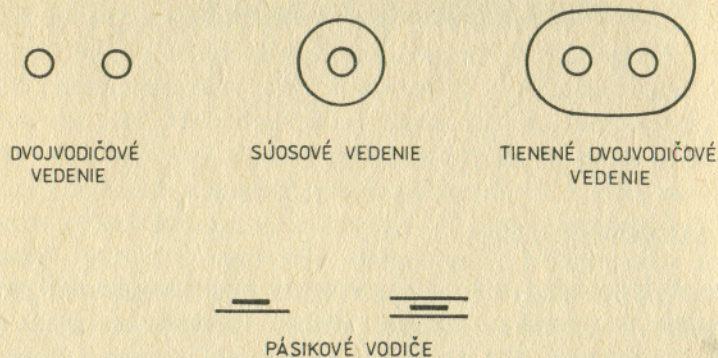
Obr. 6.1. Prierezové konfigurácie rôznych druhov homogénnych vedení
