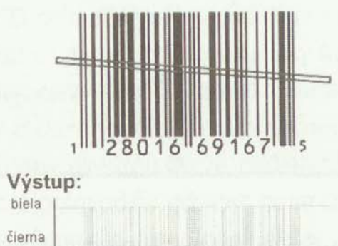
Obr. 5.8. Premena čiarového kódu na elektrický signál pri snímaní
