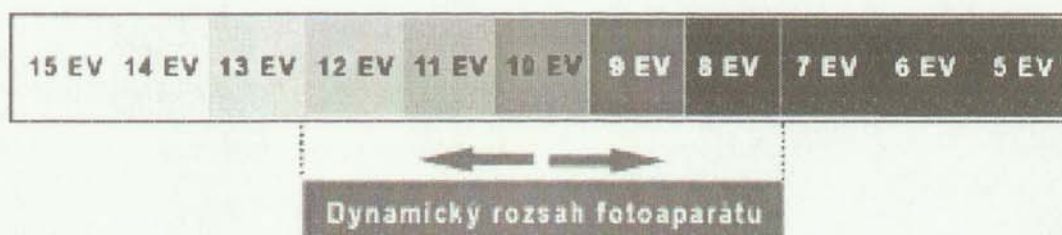
Obr. 5.29. Príklad dynamického rozsahu scény v porovnaní s rozsahom optického snímača fotoaparátu
