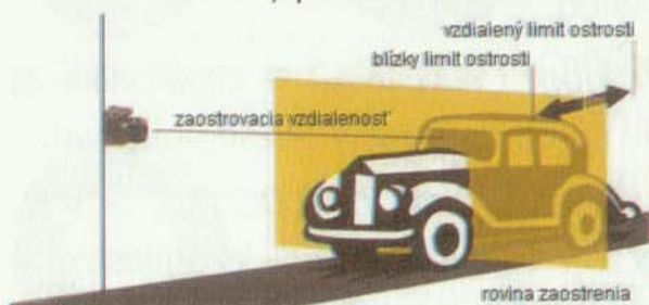
Obr. 5.39. Grafické znázornenie princípu hĺbky ostrosti
