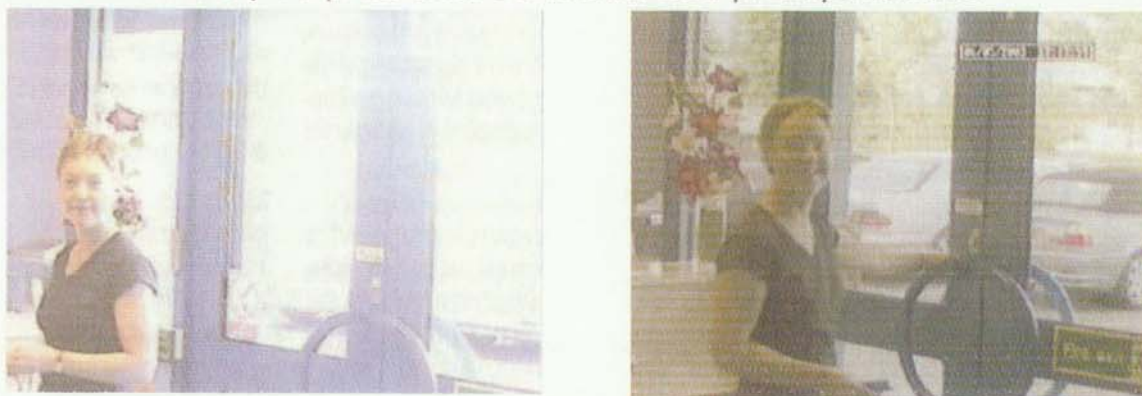
Obr. 5.27. Porovnanie dynamického rozsahu kamery s CCD a DPS snímačom
