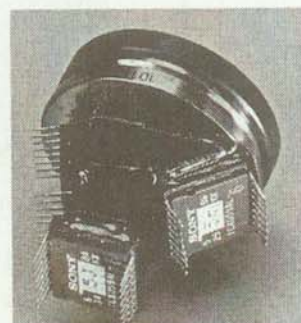
Obr. 5.17. Optický systém kamery s 3 CCD snímačmi
